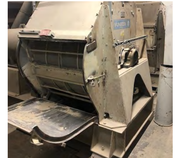
Hamermolen; binnenin de rotor met hamers aan de buitenzijde zit de zeef waar het mengsel doorheen geslagen wordt.
