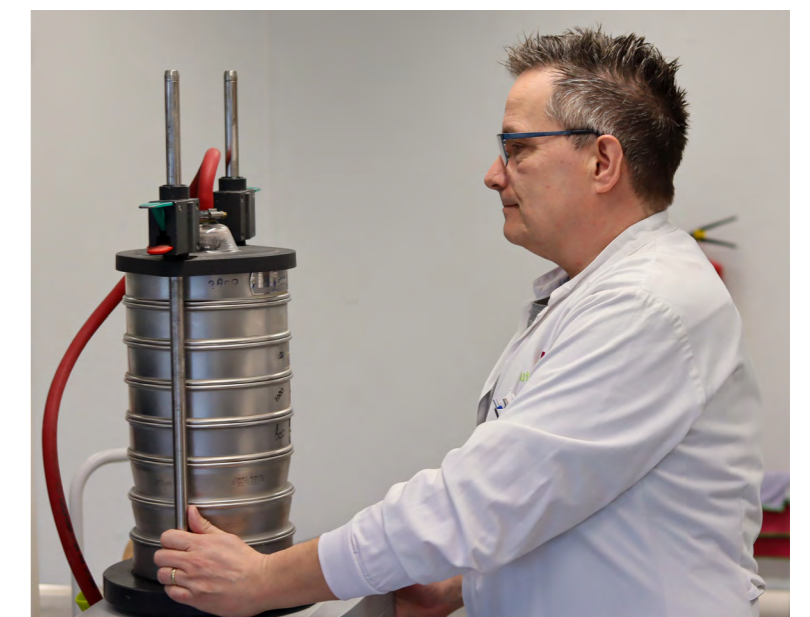
De laborant voert de natte zeeffanalyse uit. Het meelmengsel wordt door de verschillende zeven gespoeld.
