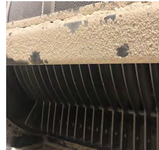
Hamermolen; onderin de rotor met hamers zichtbaar doordat de zeef verwijderd is.
